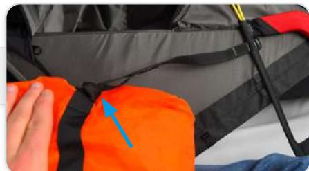
Les sangles de la sellette doivent être attachées à celle du secours par une connexion adaptée (non fournie).
