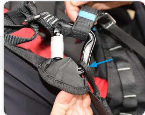
La protection peut maintenant être retroussée pour se placer ainsi en bas du mousqueton.
