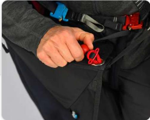
Finalement, le T bleu (situé sur le côté droit du cocon sous le cockpit) doit passer à dans l'ouverture sur le côté gauche du cocon.
