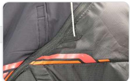
Faites finalement passer la ligne par la fente à travers le cocon en veillant à ce qu'elle ne passe autour d'aucune sangle structurelle.
