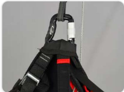
Les élévateurs de votre aile doivent être connectés à votre sellette sur les points d'ancrage principaux avec les élévateurs A tournés vers l'extérieur.
