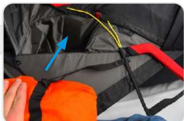
Les sangles qui connectent les maillons des épaules au parachute doivent descendre proprement dans le fourreau pourvu d'une fermeture Eclair le long du côté de la sellette jusqu'au compartiment du parachute.
