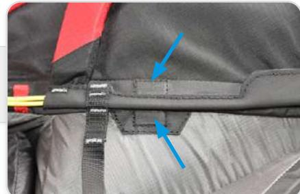
Le compartiment du secours est maintenant fermé et la poignée à sa place, il reste à fermer la fermeture Eclair à l'arrière du compartiment qui s'ouvrira automatiquement en cas d'extraction du parachute. Pour cela, soulever rabât magnétique et, sans toucher aux épingle jaunes, tirer le curseur en un va et vient complet pour fermer la fermeture avant de le positionner dans son logement.
